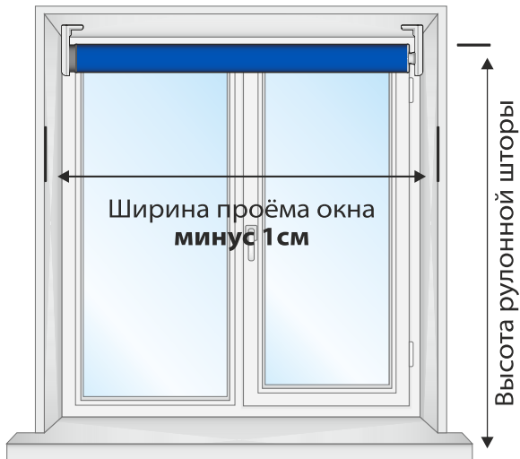
Монтаж карниза в проём окна
