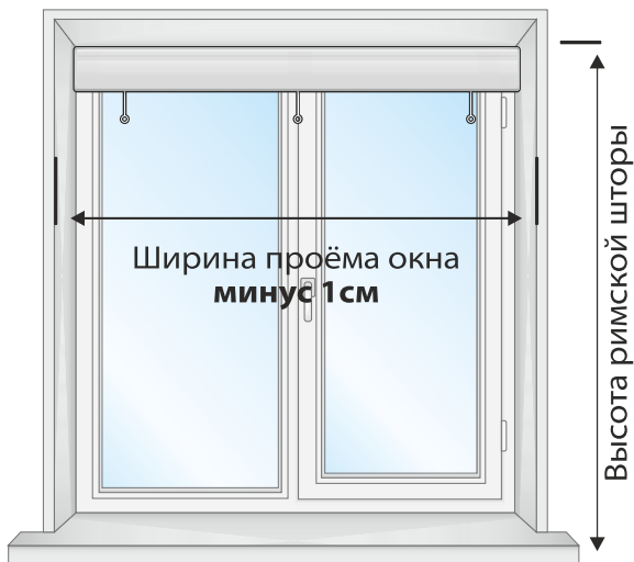
Монтаж карниза в проём окна
