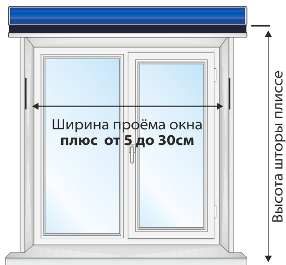
Монтаж карниза над проёмом окна
