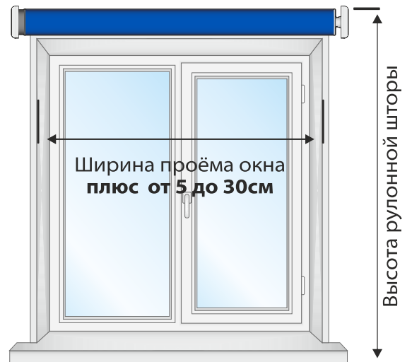
Монтаж карниза над проёмом окна
