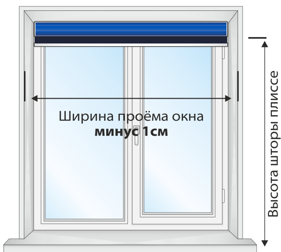
Монтаж карниза в проём окна
